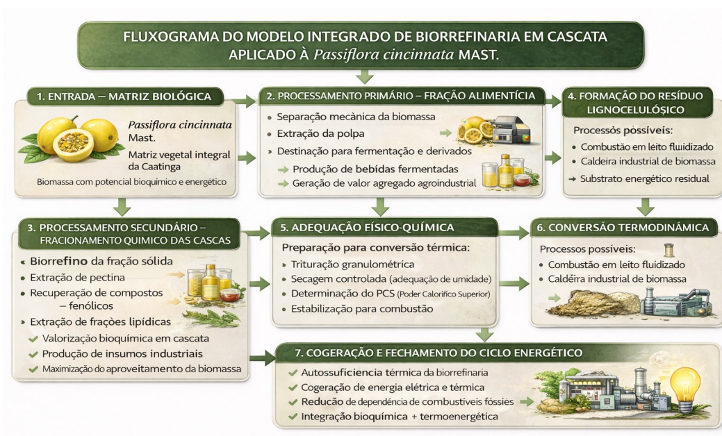
Figura 02: Fluxograma do modelo de biorrefinaria em cascata aplicado à Passiflora cincinnata , evidenciando o fracionamento bioquímico inicial e a conversão termodinâmica do bagaço lignocelulósico seco para cogeração energética e fechamento do ciclo produtivo.
