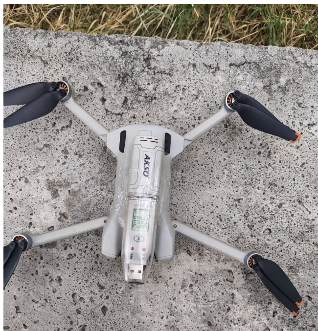
Figura 4 - Datalogger acoplado a drone
