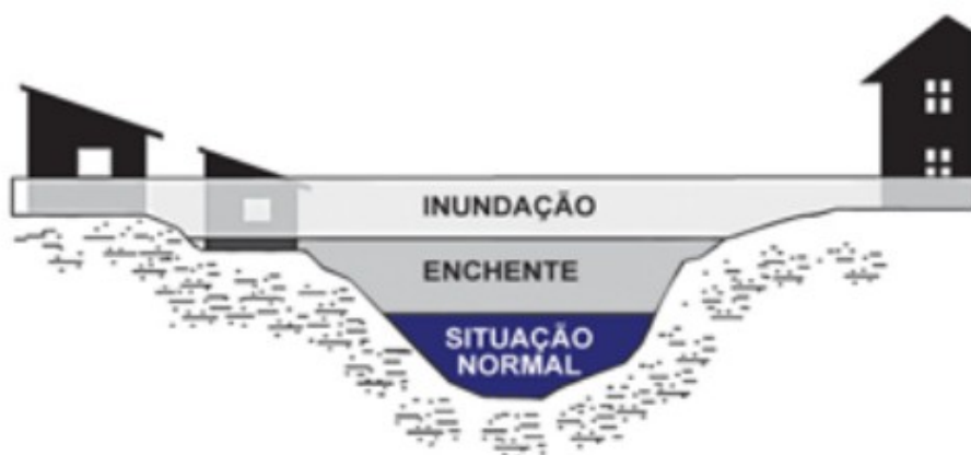
Figura 8 - Perfil esquemático do processo de enchente e inundação
