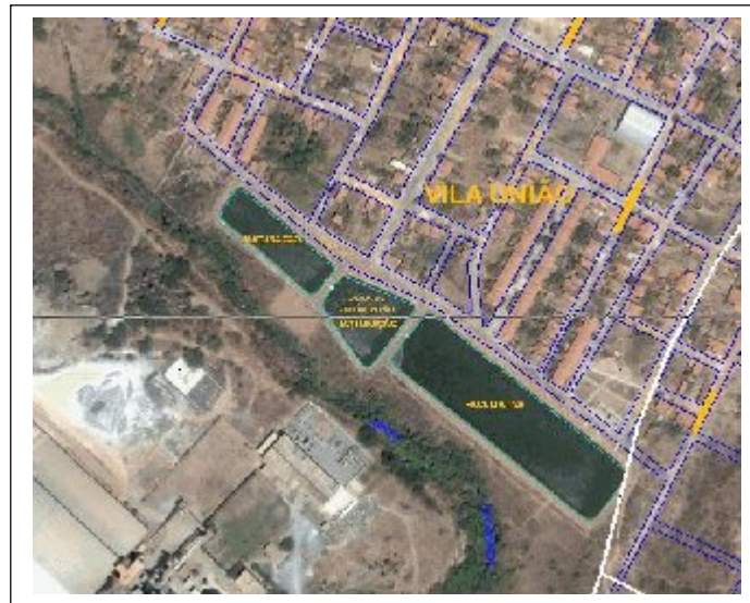
Figura 2: Vista aérea das três Lagoas de Estabilização situadas no Bairro José Euclides Fonte: Prefeitura Municipal de Sobral 92006)
