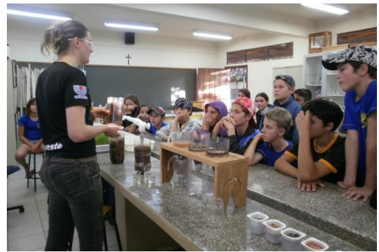
Fig. 9 - Apresentação do ensaio de infiltração em três amostras de solos. Detalhe do suporte de madeira utilizado como apoio da parte superior das garrafas.
