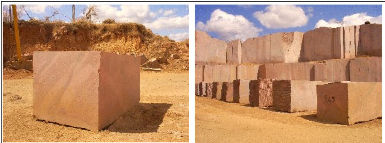
Figura 06: Blocos para beneficiamento e/ou exportação, à esquerda a face cortada com fio diamantado; à direita, o pátio de armazenamento.
